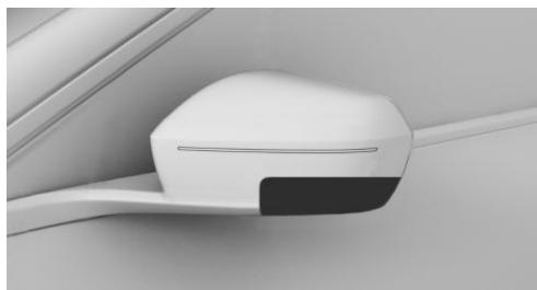
在后视镜壳体内部下方各有一个外后视镜摄像头。
