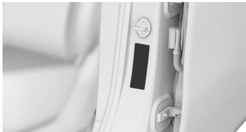
轮胎压力数据位于驾驶员侧车门门柱上的充压标志牌上。
