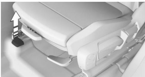
拉动座椅前部的纵向操作杆，将座椅朝所需方向推动。
