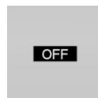
在组合仪表上显示 OFF。已关闭驱动装置并且已启用运行就绪状态。
