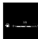
加油泵标识旁的箭头表示油箱盖板位于车辆的哪一侧。
