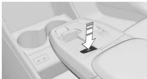
**(P)** 如需挂入选车档，按压中央控制台中的电子机械式驻车制动器按钮。
