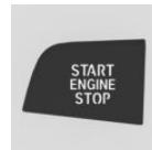
按压中央控制台中的启动/关闭按钮。控制显示器和仪表板亮起。
