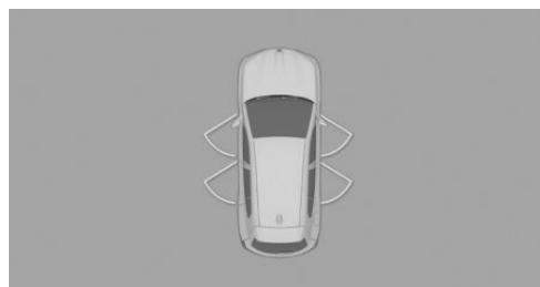
在挂入选档杆位置 P 时显示车门最大开启角度。
