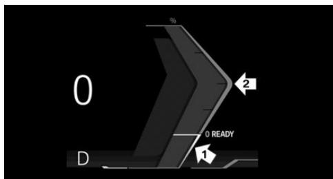
箭头 1 区域中的指针: 制动能量回收系统的显示, 如减速时, CHARGE。
