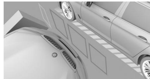
在车辆侧向显示障碍物标记以保护车辆侧翼。
