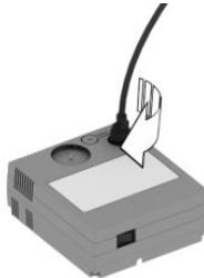
3. 松开并拆下车轮上的阀门盖, 再将软管的连接件拧到阀门上。
