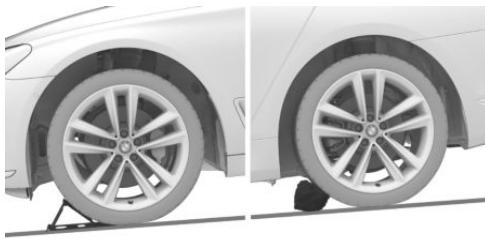
如果需要在缓坡上更换车轮，则在滚动方向的反方向将楔形件或其他适当的物体（例如石块）放在前桥和后桥的车轮下方。
