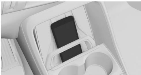
将移动电话垂直插入固定架后的中间位置，并将其向下推至极限位置。移动电话显示器必须朝上。
