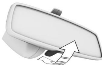
向前倾斜车内后视镜上的操作杆，可降低车内后视镜导致的眩目效果。
