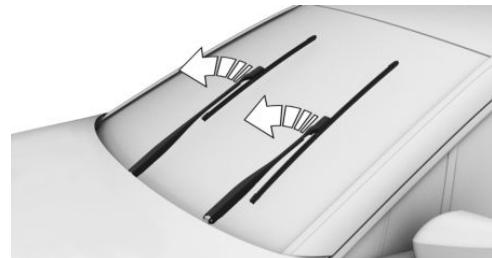
3. 在雨刮器上按压按钮（箭头 1），稍微顺时针转动雨刮器刮片并向前拉出（箭头 2）。
