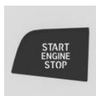
通过中央控制台中的启动/关闭按钮启动或关闭行驶就绪状态。
