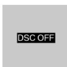
在动态稳定控制系统已停用时，在组合仪表上显示 DSC OFF。
