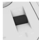
按压中央控制台中的滚轮。控制显示器和仪表板亮起。
