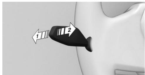
向前按压或向后拉转向信号灯远光开关。
