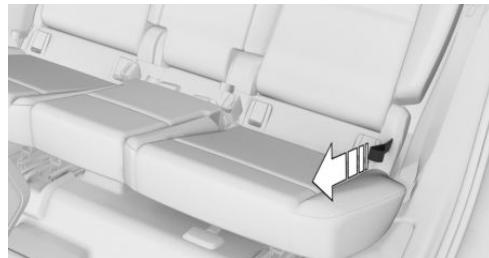
拉动座椅侧面的拉环并将后座椅靠背向前翻折。
