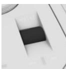
按住中央控制台中的滚轮，直至组合仪表上的 OFF 显示熄灭。
